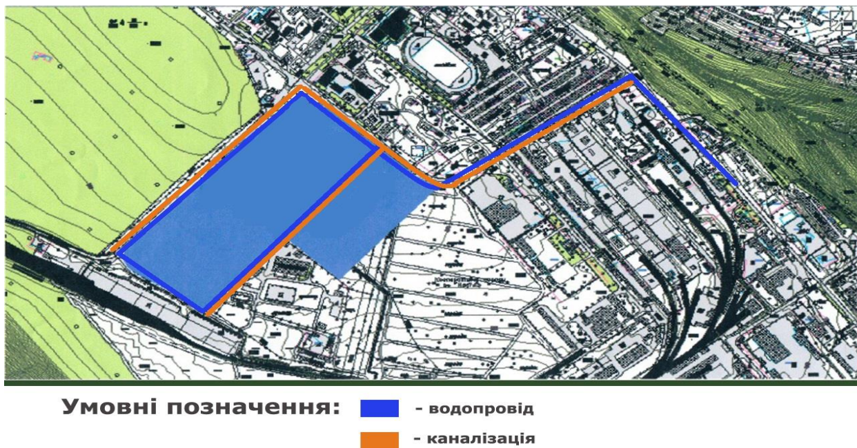
Рис. 7.3. Схема підведення води та каналізації до ділянки ІП
